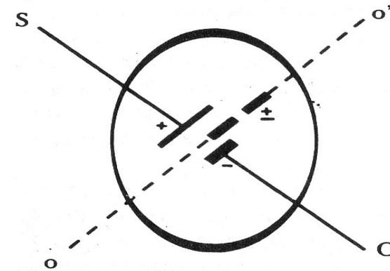
Cuando la corriente pasa por el circuito se produce en ese dispositivo un bombardeo electrónico del cátodo hacia el ánodo. Si la placa transversal está polarizada positivamente, los electrones siempre serán conducidos hacia el ánodo y la corriente pasará. En cambio, si está polarizada negativamente, los electrones negativos que provienen del cátodo serán rechazados por la placa negativa y la corriente ya no pasará.
